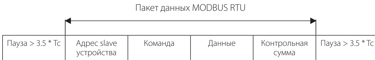
Рис 8-5 Структура пакета MODBUS RTU
